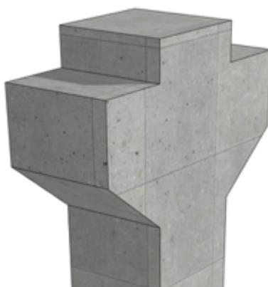
Программа предназначена для подбора арматуры и расчёта прочности короткой железобетонной консоли согласно СП 63.13330.2018, и п. 3.34 СНиП 2.03.01-84\*. Предельные усилия вычисляются на основе диаграмм деформирования сжатого бетона и арматуры.
