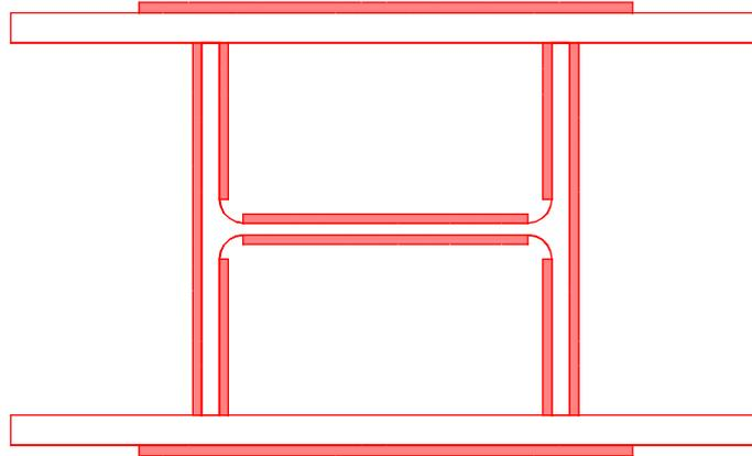
Проверка прочности швов (случай  $\beta_f R_{wf} \leq \beta_z R_{wz}$ )
