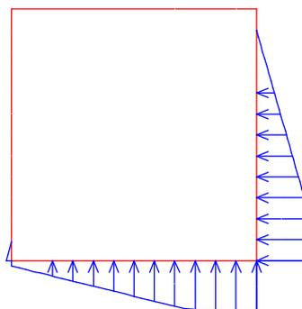
**Проверка прочности опорной плиты**
