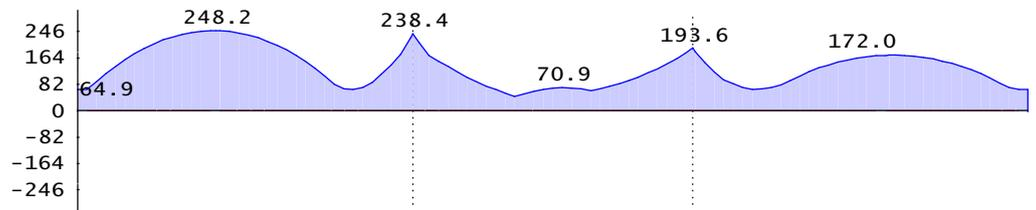
Максимум эквивалентных напряжений по формуле (44) достигается в сечении с координатой  $x = 2.47\text{м}$
