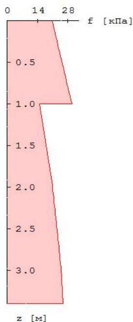
Рис. 4. Пример эпюры сопротивления грунта
